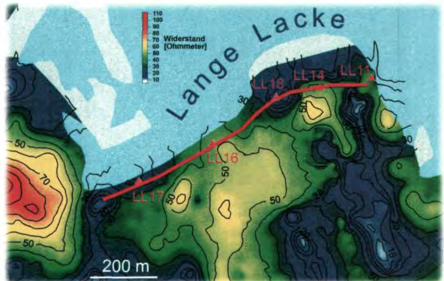
Karte des elektrischen Widerstandes zur Identifizierung bevorzugter Grundwasserwege.
