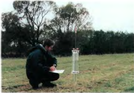
Das Guelph – Permeameter zur In-situ-Messung der hydraulischen Leitfähigkeit von Böden
