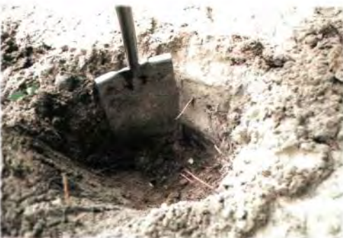
Datendokumentation im Feld Bodenprobeentnahmestelle Bodenprobennahme mit einem Nirostaspaten
