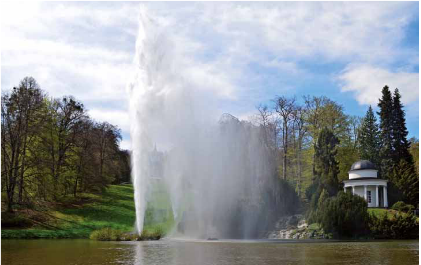
Abb. 4: Aufgrund der 80 Meter Höhendifferenz zwischen Fontänenreservoir und Fontänenteich steigt die Große Fontäne, wie ein Geysir, ca. 50 Meter in die Höhe. Foto: Hoff
