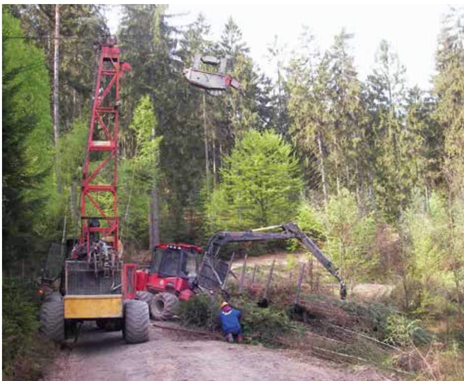
Abb. 4: Seilkrantransport entnommener Bäume zum Waldweg und anschließende Aufarbeitung durch einen Harvester (Foto: S. Hering)
