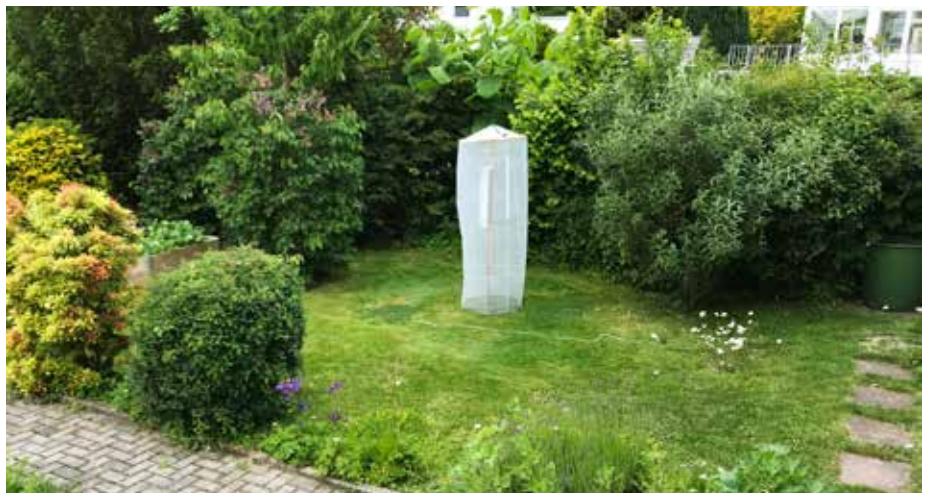
Abb. 2: Hinterer Gartenbereich mit Leuchtturm und netzbetriebener 2x 18-Watt-Anlage (Foto: K. Földner)
