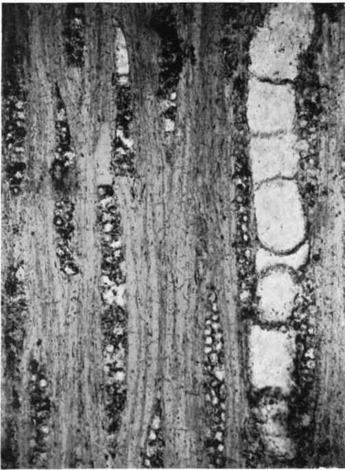
Abb. 3 Tangentialschliff mit Marktstrahlspindeln und einer Wasserleitbahn (rechts)
