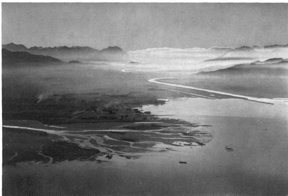
Luftbild 5347 von Paul Strähle, Schorndorf Tafel 2a Rheindelta im Bodensee 1926. Vorn Delta der Bregenzer Ach, noch nicht korrigiert. Dahinter die neue Rheinmündung von 1900 mit weit vorstechendem Leitdamm. Man vergleiche damit die 32 Jahre spätere Aufnahme Tafel 1. Miterlebte Geologie!
