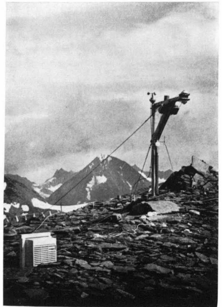
Abb. 5 Elektrische Geräte messen ganzjährig Temperaturen, Strahlung und Helligkeit auf dem Versuchsplatz.
