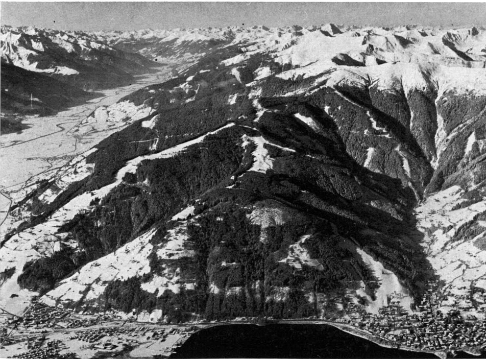
Abb. 10 Gut in die Landschaft eingefügte Skipisten bei Zell am See. Durch den Verlauf auf den Rücken entstanden „Rundschneisen“, die den Wasserabfluß besser regeln lassen. Guter Feuerschutz. Foto: Schmittenhöhebahn AG, Zell am See.
