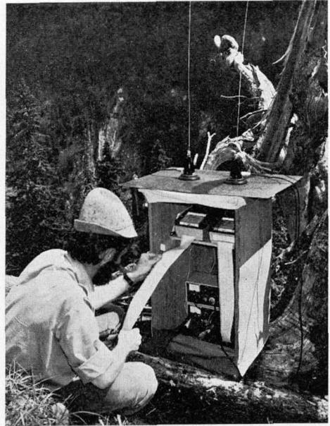
Abb. 8 Empfangsanlage zur automatischen Aufzeichnung der Tagesperiodik von Rothirschen.
