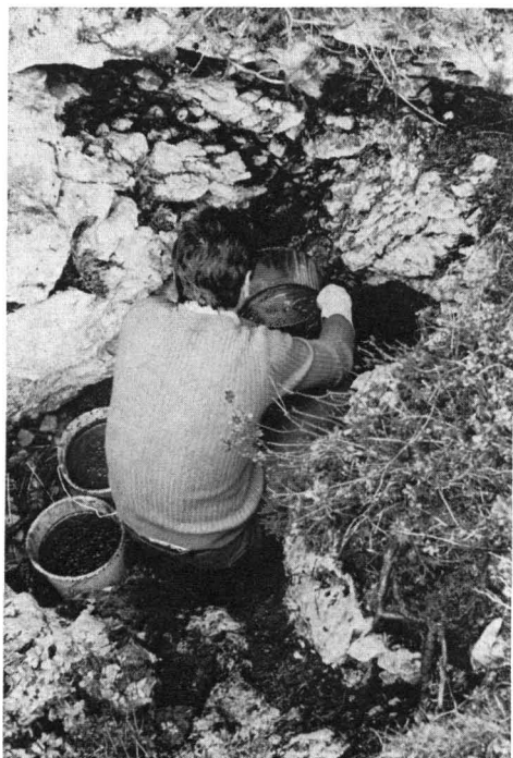
Abb. 10 Karstwassermarkierungsversuch im Tennengebirge im Herbst 1977. — Einspreisung von in Wasser gelöstem Farbstoff Rhodamin B in einen kleinen Karstschant nördlich der Pitschenberg-Lacke.
