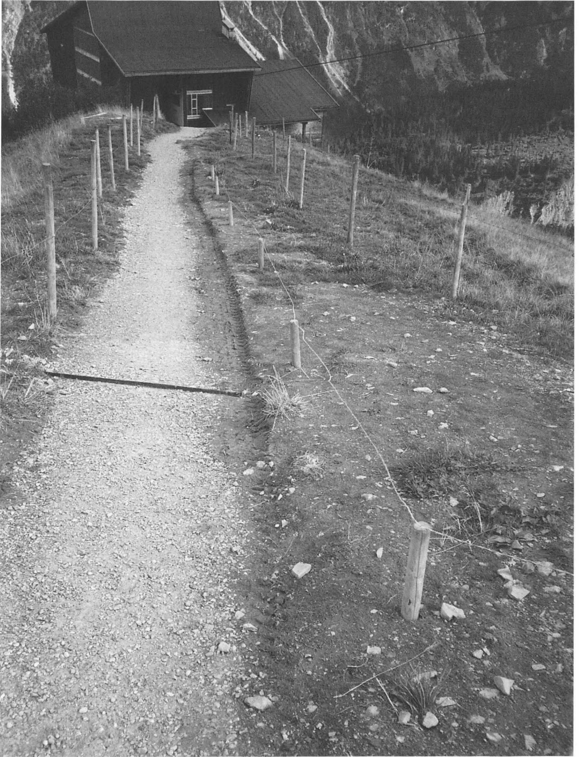
Foto 7: Teststrecke für Absperrungen parallel zum Weg: Hoher und niedriger Drahtzaun verhinderten zu fast 100% das Verlassen des Weges. (Oberhalb der Fellhornbahn-Bergstation, Sommer 1990)
