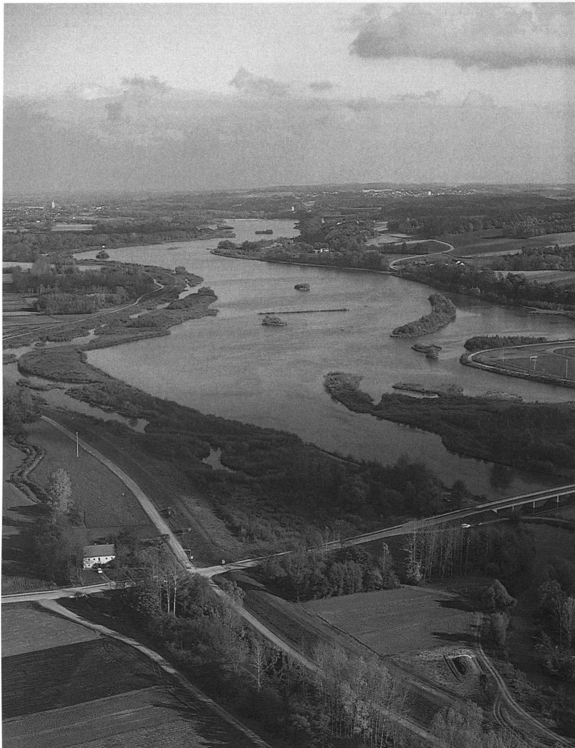
Abb. 10: Die als Folge von Regulierungen stark eingetieftete Isar wurde bei Landau durch ein Stützkräftwerk stabilisiert. Im Stausee und im umgebenden Auwald mit seinen Altwassern und Bächen wurde mit gezielten Maßnahmen eine Revitalisierung eingeleitet.
