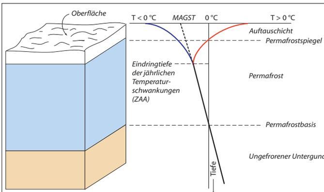
Abb. 2: Schematische Darstellung der wichtigsten Begriffe im Zusammenhang mit Permafrost sowie eines typischen Temperaturprofils. Die rote und blaue Kurve entsprechen den wärmsten Temperaturen im Sommer, respektive den kältesten im Winter. Mit MAGST wird die mittlere jährliche Oberflächentemperatur bezeichnet (mean annual ground surface temperature).
