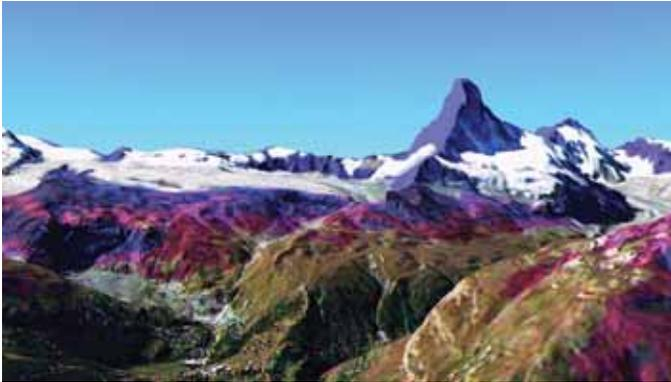
Abb. 1: Modellierter Permafrostverbreitung im Gebiet Matterhorn-Zermatt (CH). Dunkelviolett ist das Gebiet mit wahrscheinlichem, hellviolett das mit möglichem Permafrost dargestellt. (S. Biegger und S. Gruber, Satellitenbilder: ESA/Eurimage®, CNES/Spotimage, swisstopo/NPOC. Höhenmodell: DEM25, 2003 swisstopo®)
