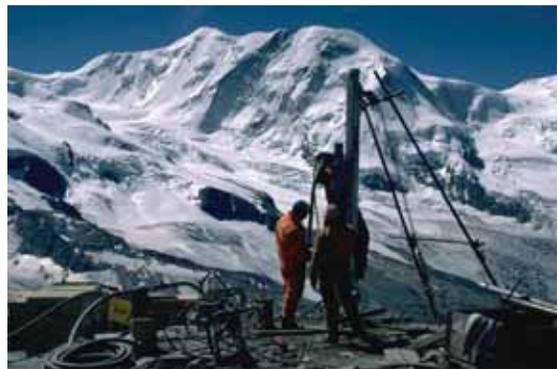
Abb. 6: Bohrung eines 100 m tiefen Bohrlochs nahe dem Stockhorn (CH, 3400 m ü. M.) oberhalb von Zermatt. Die Bohrung wurde 2000 im Rahmen des EU-Projekts PACE erstellt und seither werden darin kontinuierlich die Temperaturen des Untergrunds gemessen. Im Hintergrund sind der Gletscher und der Lyskamm sichtbar.
