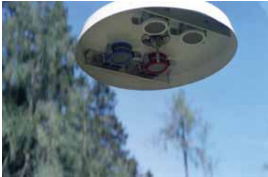
Bild 9: Passivsammler zur Messung von Ozongehalten der Luft an der WKS Berchtesgaden.
