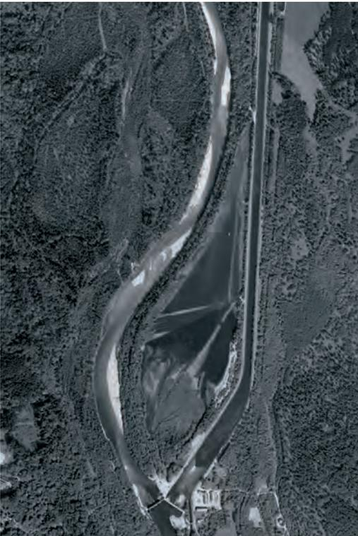
**Abb. 9 (oben links):** Isar, Ickinger Wehr mit Werkskanal zum Kraftwerk Mühlthal im Bau (1925). Die Wildflusslandschaft mit den noch ausgedehnten Kiesbänken wird in ein kanalartiges Gerinne gefasst. (Quelle: Wasserwirtschaftsamt München).
