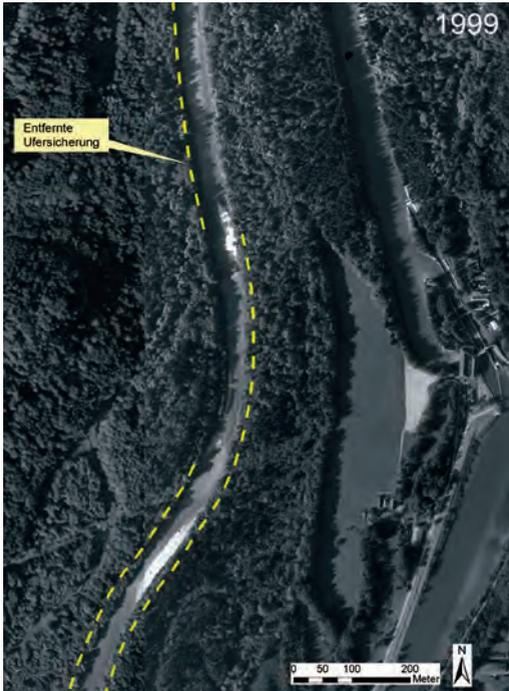
Abb. 14 (oben links): Die mit starren Uferverbauungen festgelegte Isar auf Höhe des Kraftwerks Mühlthal 1999. Gelb gestrichelt die verbaute Uferlinie 1999 (Quelle: Bayerisches Landesvermessungsamt).
