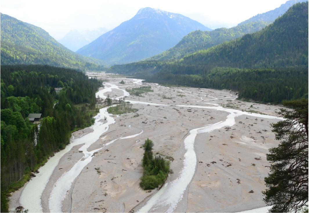
**Abb. 16:** Die Mündung des Rißbachs in die Isar (re. unten) bei Vorderriß während dem abklingenden Hochwasser im Juni 2013. Der Rißbach ist ein wichtiger Geschiebelieferant der Oberen Isar und mitbestimmend für die Dynamik in den flussab liegenden Abschnitten (Foto: F. Speer, 19.6.2013).
