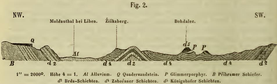
trisch-schalenförmigen Bau, wie ihn Barrande in seinem idealen Querprofile des böhmischen Silursystems entworfen hat, vollkommen dar. Das voranstehende Profil stellt die Schichtenlage zwischen Kobylis und den Kunraticer Höhen dar. Man ersieht daraus, dass die Brda-Schichten am Kreuzberge bei Volšán sattelförmig aufgerichtet sind und die ganze Partie in zwei Mulden theilen; die eine enthält das Moldaualthal zwischen Prag und Libeň, die andere das flache Hügel-land zwischen Volšán und Litochleb.
