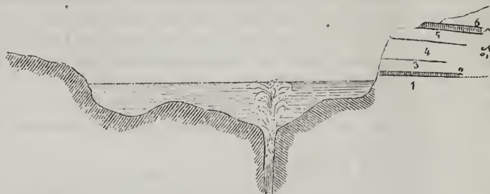
1 Teichschlamm mit Melanopsis , 2 alte Humusschichte, 3 Kalktuff mit Planorbis , 4 Sand (grau) mit Melanopsis , 5 Sand (gelb) mit Melanopsis und Neritina , 6 neue Humusschichte: zusammen 2 Klafter mächtig.
