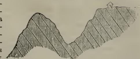
Schichtfläche unter 50—60 Grad, Schieferfläche unter 80 Grad östlich einfallend.
