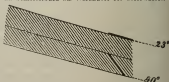
Die Schichtfläche unter 23 Grad, die Schieferungsfläche unter 40 Grad östlich einfallend.
