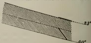
Die Schichtfläche unter 23 Grad, die Schieferungsfläche unter 40 Grad östlich einfallend.
