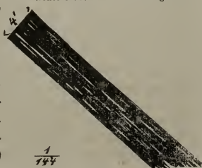
Das erste Flötz der Ferdinandizeche in Okrouhlik durchwachsen mit graubraunem Schieferthon in dünnen Lagen.
