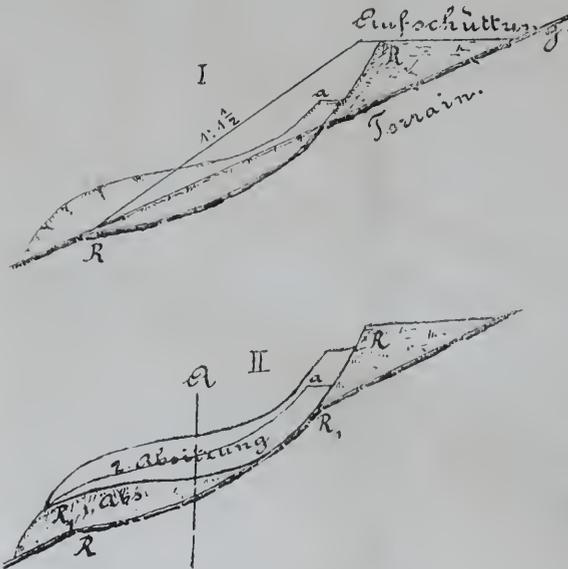
Die in der nun sistirten Anschüttung vorgenommene Abteufung eines Sondirschachtes ergab eine ganze Reihe übereinander liegender Spiegel in den anstehend gewesenen Lehm Massen. Der in Fig. 7 I schematisch dargestellten Absitzung folgte der in II veranschaulichte Process: Durch abermalige Aufbringung einer Last schob sich ein Theil der bewegten Masse in einer neu entstehenden Trennungsfläche über das weiter unten oder tiefer liegende, zum Theil vielleicht schon langsamer im Fortschreiten begrif-
