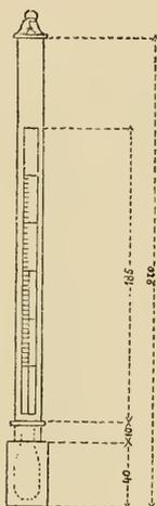
Für die Beobachtungen verwendete ich eine aus beigegebener Skizze ersichtliche Thermometer-Construction, mit welcher ich schon im Sonnstein-Tunnel arbeitete und welche ich sehr praktisch verwendbar fand. Die am Quecksilbergefässe angebrachte abschraubbare Hülse wurde zur Isolirung mit reinem Oel gefüllt und hielt dieselbe bei Beobachtung der nöthigen Vorsicht bis über eine Minute vollkommen den bereits angenommenen Temperaturgrad.
