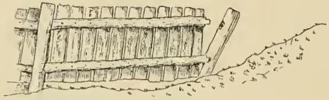
oberen Querbalken ist zerrissen, der Pfahl hat sich um die Verbindungsstelle mit dem unteren Querbalken oben nach SW. gegen den Abhang zu geneigt, als wäre der Erdboden unter ihm horizontal nach NO. verschoben worden. Die Grösse dieser Verschiebung muss mindestens 15 Centimeter betragen haben.
