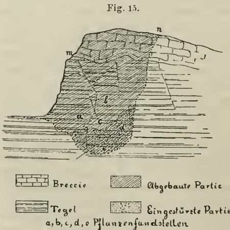
Nord-Süd-Schnitt durch die Tegelgrube.
