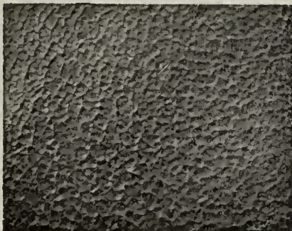
Zarteste Sculptur, erzeugt auf einer vorerwärmten Colophoniumfläche durch momentane Einwirkung des Dampfstrahles. Vergrößerung: 2:1.
