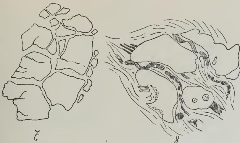
als Anfang der Strahlquarzbildung erscheint. Fig. 7 und 8 zeigen die Zertrümmerung von Quarzkristallen infolge Korrosion und Zerschwemmung. In Fig. 7 löschen die Trümmer noch beinahe gleichzeitig aus, in Fig. 8 sind sie bereits durch die Grundmasse auseinandergeschwemmt, die letztere zeigt deutliche Merkmale des Geflossenseins. (Liegendes der Erzlager, Spielkugel etc.)
