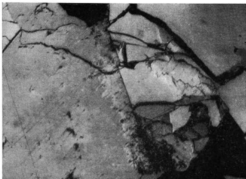
Abb. 21: Vergr. 80 \times . Pentlandit (hellgrau) stößt an ein Pyritkorn (weiß). Die dem Kupferkies (grau) zugekehrten Pentlandit-Spitzen führen weiße Millerit-Säume. Diese Millerit-Säume sind unter hydrothermalen Bedingungen in Millerite umgewandelte ehemalige Pentlandite.
