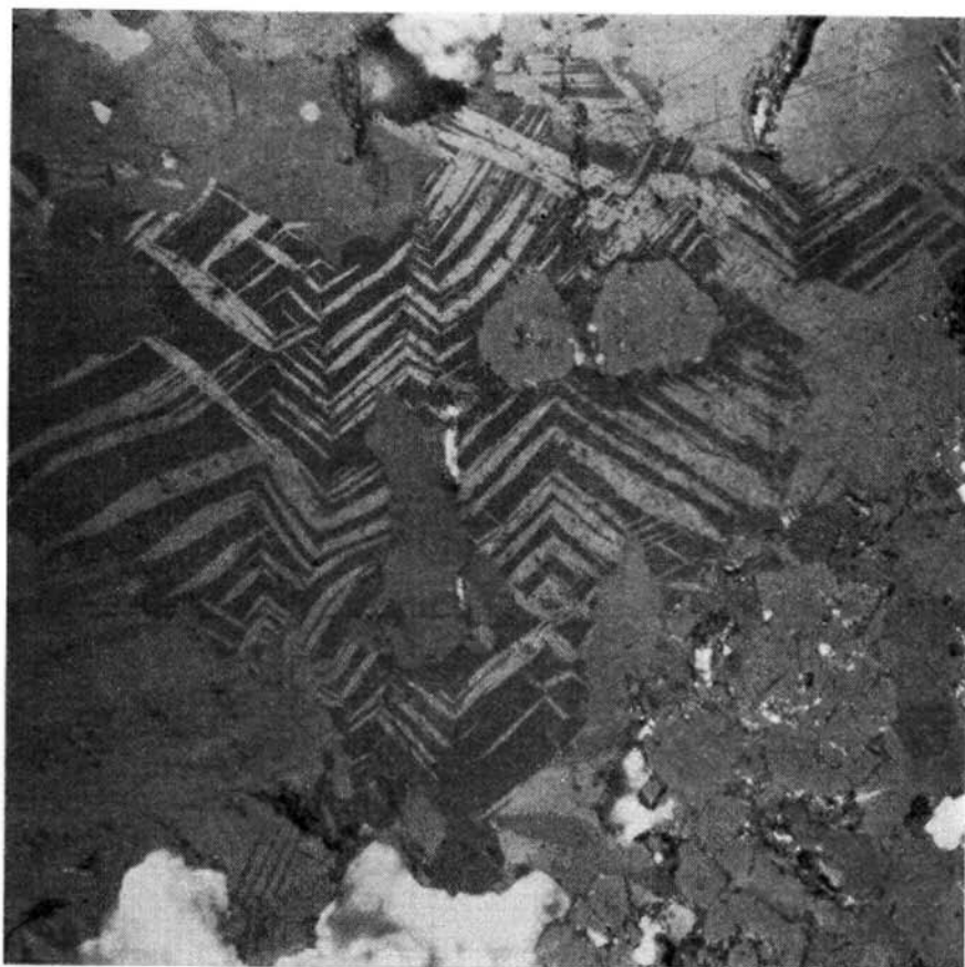
Abb. 9: Vergr. 60×, Nicols gekreuzt. Deformierter Kupferkies II mit Pyrit-Einschlüssen.
