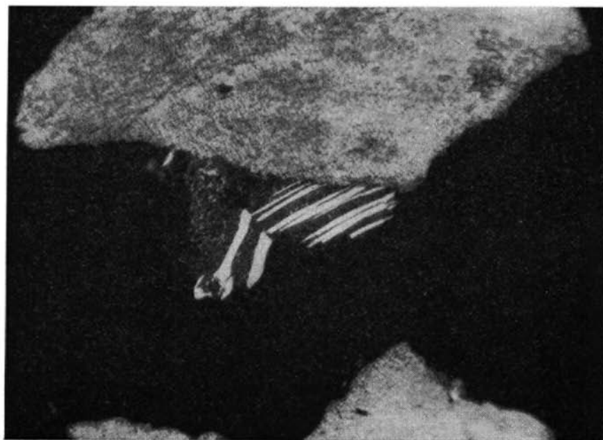
Abb. 16: Vergr. 40×. Markasit (weiß) ist mit Magnetkies (geätzt = dunkelgrau) verwachsen. Kupferkies (geätzt = hellgrau) und Quarz (schwarz) umschließen die Markasit-Magnetkies-Verwachsung.
