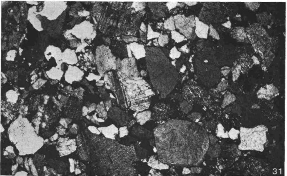
Abb. 31: Überblick über eine Arkose aus den marinen Grestener Schichten. Quarz und Plagioklas (teilweise polysynthetisch verzwillingt und saussuritisiert) als terrigene Komponenten. — Westufer des Laudachsees bei Gmunden (255/1). Gekreuzte Nicols, 25× vergrößert.
