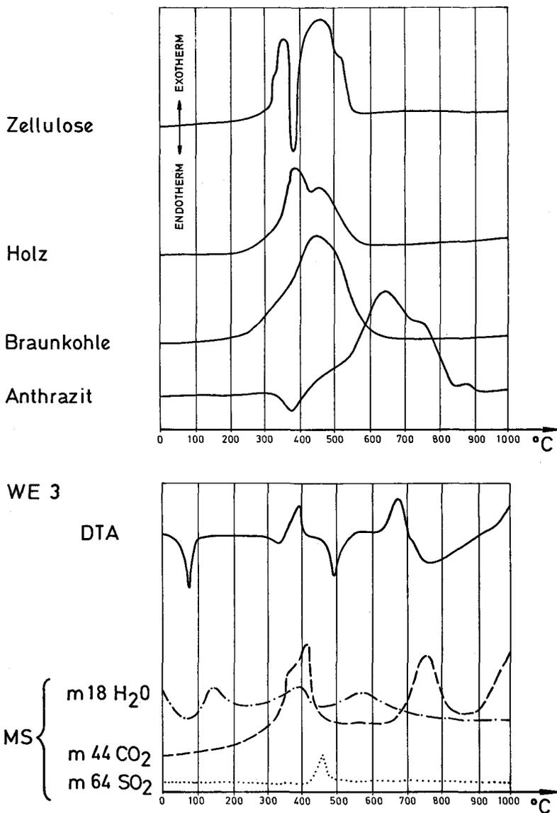
Abb. 10: DTA- und Massenspektrometerdiagramme. Schematische DTA-Kurven für Zellulose, Holz, Braunkohle und Anthrazit. DTA- und MS-Kurven der Probe WE 3.
