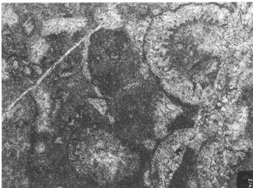
Abb. 12: Stark umkristallisierte, intraklast- und lumpreiche, pelletoidhaltige Spatite mit Dasycladaceen. – Wettersteindolomitfazies des Ladin, Faziestyp (2), Unterfazies (b 1) des Benzecks (Grapestone-Lump-Fazies); Probe 154/3, Vergrößerung 115x; Entnahmestelle der Probe: Benzwände, ca. 700 m NE' der Latschenhütte am Benzeck.
