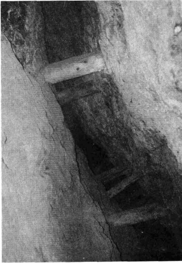
Abb. 1: Typisch lagerförmiger Abbau einer steilstehenden Goldquarzitlage. Revier Hainzenberg. Aufn. H. WENGER, 1980.
