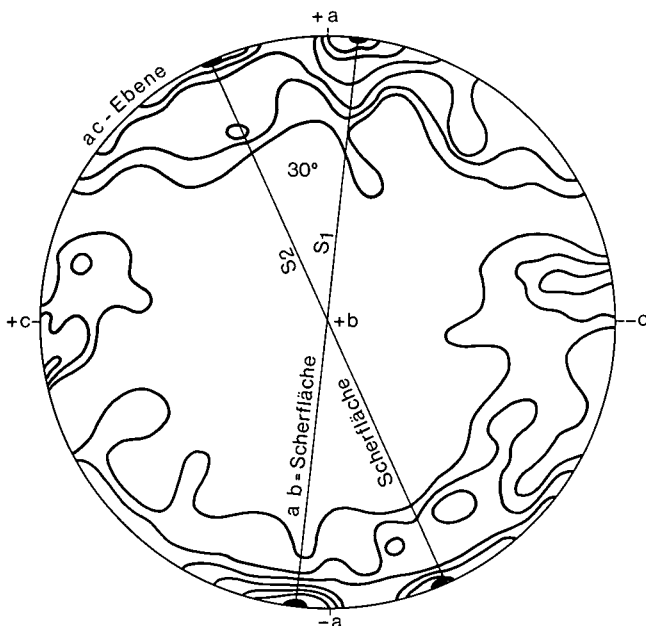
Abb. 6: U-Tisch Position des orientierten Dünnschliffes 10351. Untere Halbkugel, LAMBERT'sche Projektion, 1 %-Auszahlkreis. 387 Quarz-c-Achsen der Schriftgranit-Quarze. 176 in der ac-Ebene (CHRISTA's Typ „straffe Häufung“), 211 innerhalb und außerhalb der ac-Ebene (CHRISTA's Typ „aufgelockerte Häufungen“). Isopyknal: 12,7 – 10,3 – 7,8 – 5,1 – 3,1 – 2,0 – 1,3 – 0,8 %.
