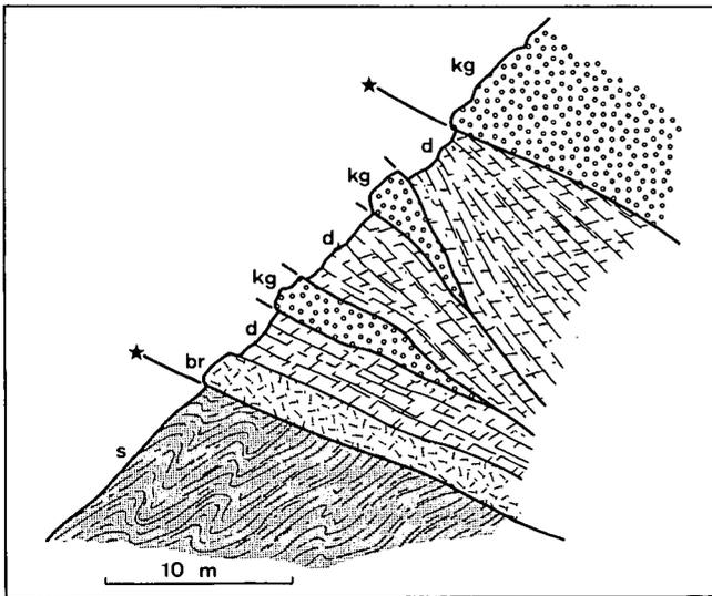
Abb. 14: Eine aus Dolomit (d) bestehende und mit Konglomeratlinsen (kg) der Konglomerat-Einheit verschuppte Deckscholle des Karbonatgesteins-Komplexes liegt mit tektonischem Kontakt über Schiefer (s) des ophiolithischen Melange-Komplexes. Entlang der Überschiebungsbahn ist eine tektonische Brekzie (br) entwickelt. Im Hangenden wird die Deckscholle von den Konglomeraten (kg) der Konglomerat-Zone überfahren. Aufschluß im Ostabschnitt des Gebietes.
