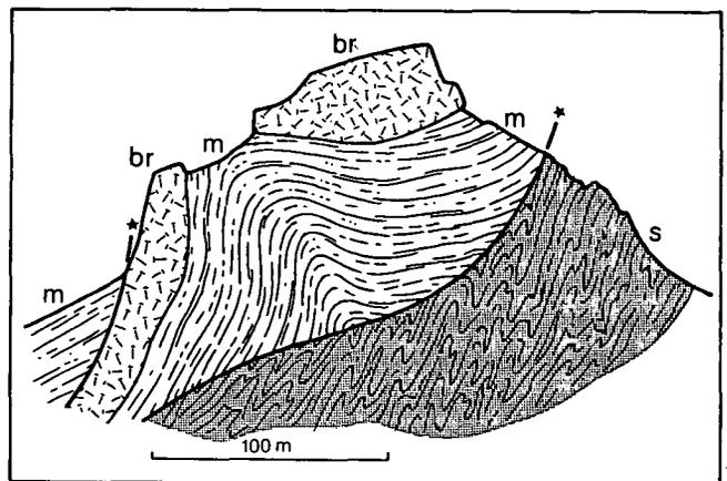
Abb. 13: Eine Deckscholle des Karbonatgesteins-Komplexes auf Schiefer (s) des Melange-Komplexes aufgeschoben. br = Kalkbrekzie; m = Mergel. Aufschluß im Gebietsmittelabschnitt.
