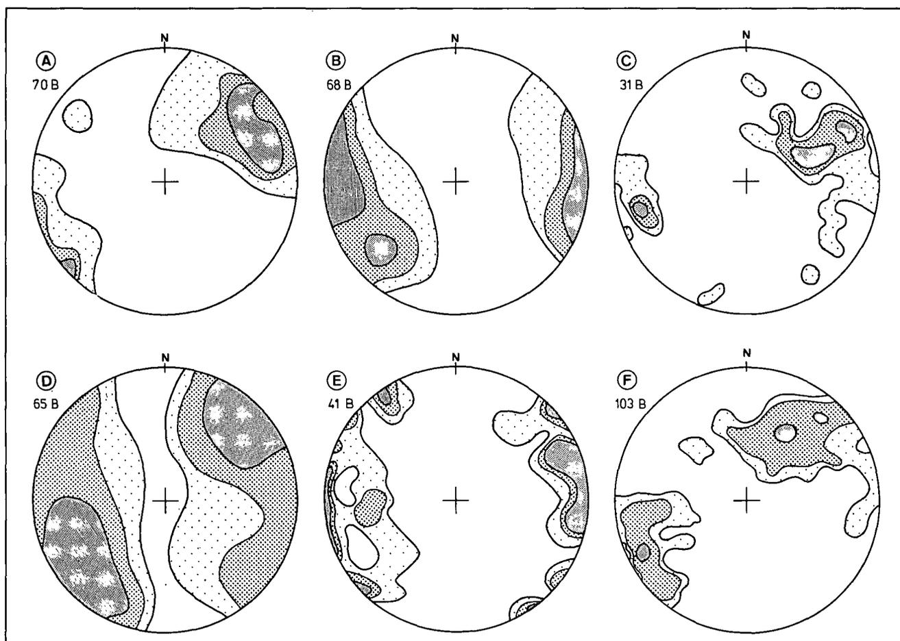
Abb. 9: Sammeldiagramme zur regionalen Verteilung der mesoskopischen Faltenachsen in Matrixschiefern des Melange-Komplexes. Sämtliche Diagramme aus dem Mittelabschnitt des Melange-Komplexes.
