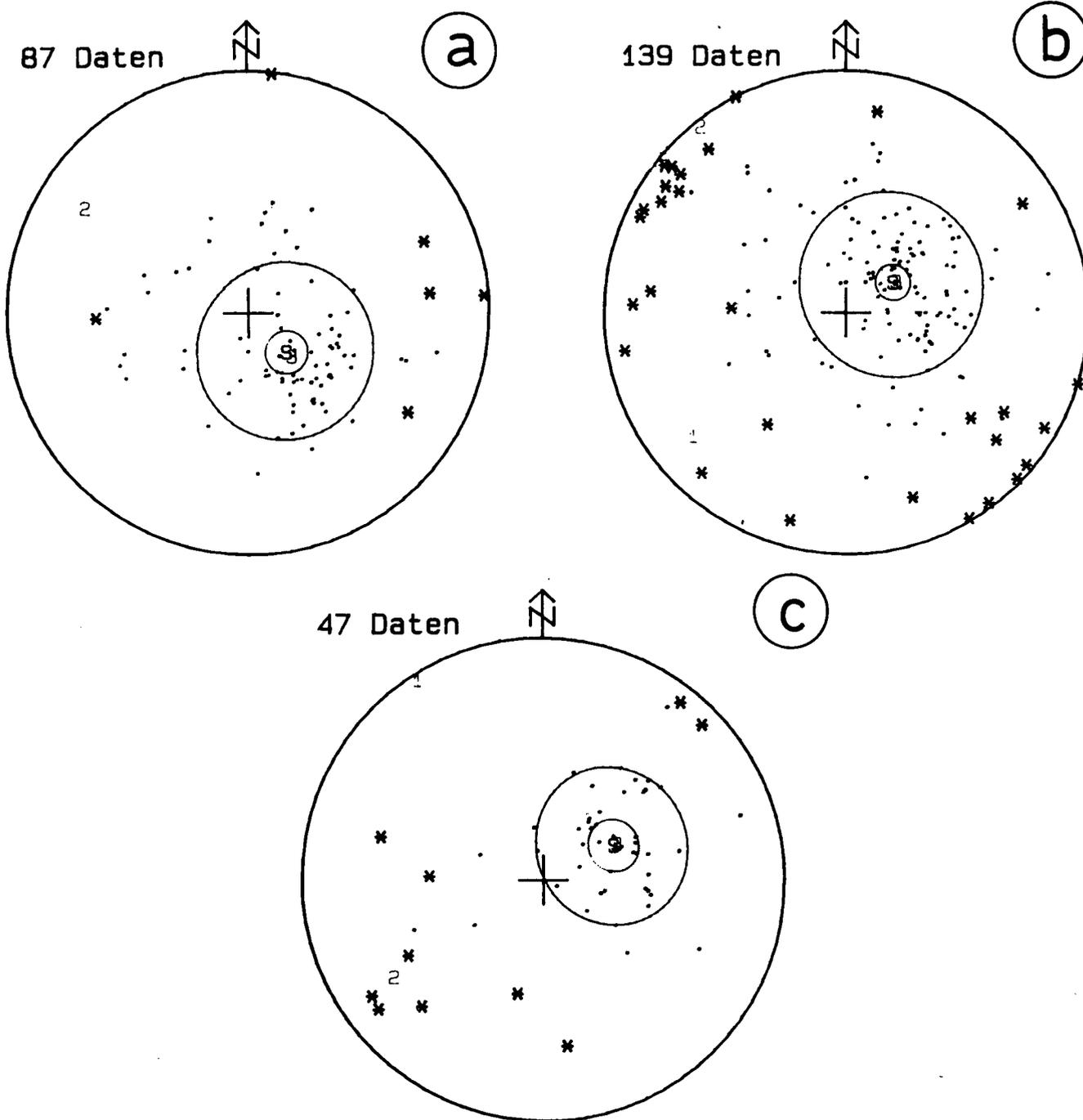
Abb. 5. Gefügedaten in der LAMBERT-schen Projektion (SCHMIDT'sches Netz).
