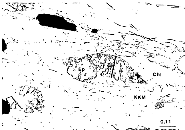
Abb. 11. Postmylonitische Chloritisierung eines Mylonites und dadurch fast vollständige Umwandlung in einen Chloritschiefer. Matrixinseln aus Albit-Oligoklas (KKM) schwimmen in Chlorit (Chl). Besonders deutlich die hydrothermale Korrosion an Epidot (Ep) mit markanter Zwillingslamelle (ZE). Schwarz = Sulfide. Nicols ||.
