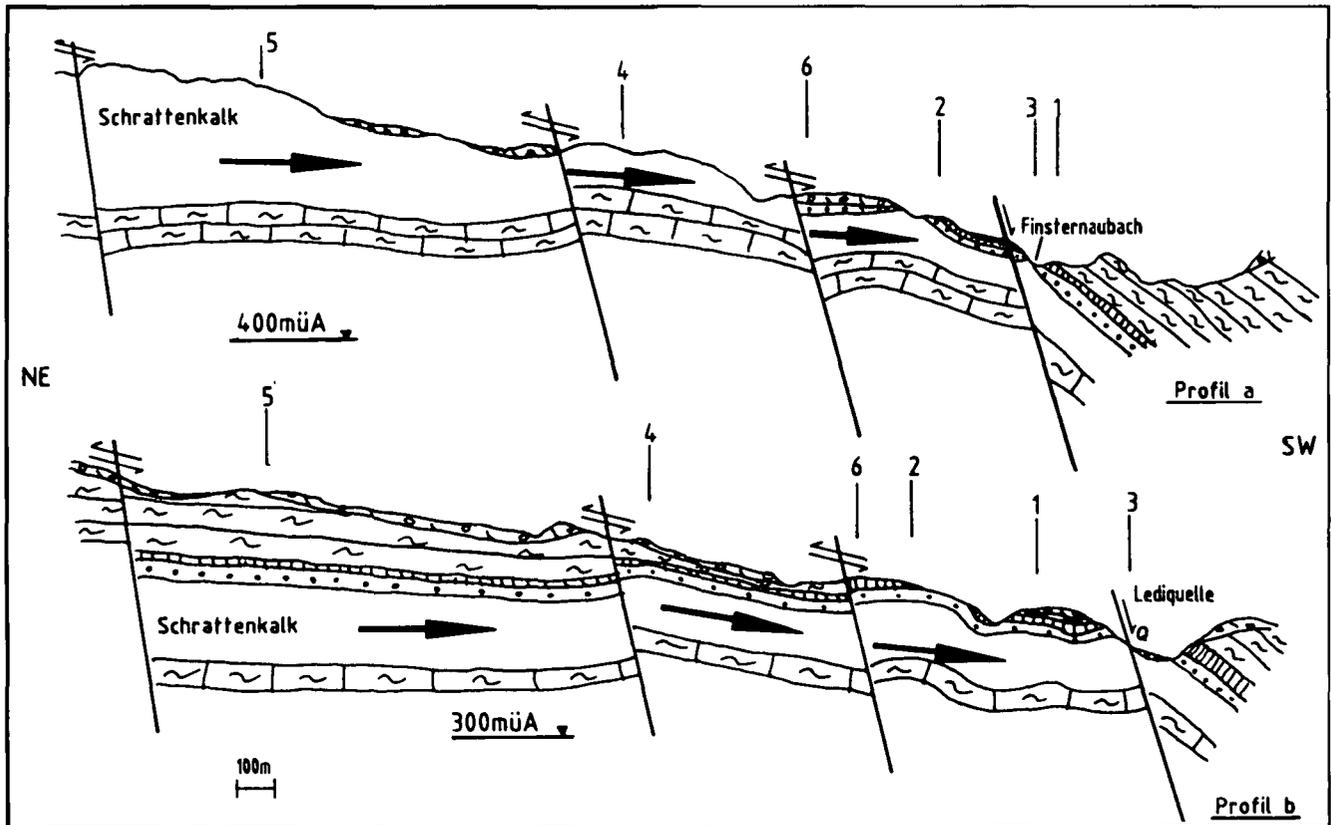
Abb. 6. Lediquellen Hohenems: Achsialschnitte der Alimentsationswege durch die verkarsteten Schraffenkalkschenkel des Ranzenberg-Staufenspitz- und des Götznberg-Strahlkopf-Bocksbergsgewölbes.
