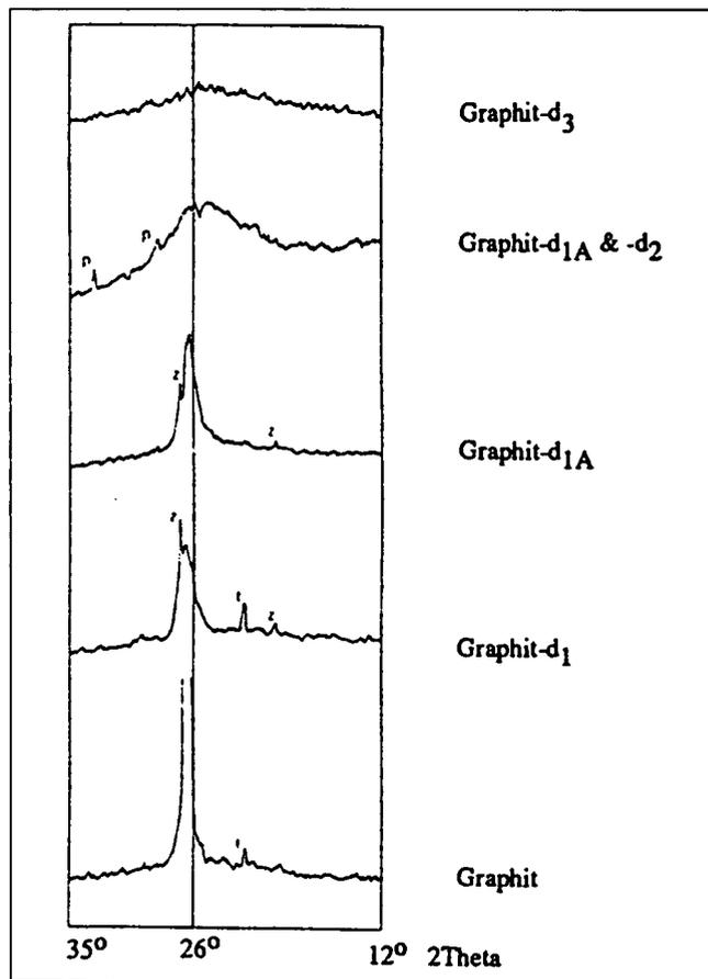
Abb. 2. Diffraktogramme von säureunlöslichen Rückständen metamorpher Sedimente. Von oben nach unten zunehmende Kristallinität von Graphit, die an der Intensität und Lage des (002)-Reflexes zu erkennen ist (LANDIS, 1971).
