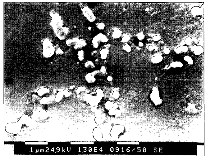
Abb. 7. REM-Foto der „<0,5 µm“-Fraktion (Nr. 1, Hochkönig) aus Proben des Südrandes der unterlagernden Tirolikum-Decke. Text-Fig. 7. SEM photograph of the „<0,5 µm“ fraction (No. 1, Hochkönig) from the southern end of the underlying Tirolikum nappe. The rounded shape of the illites and chlorites (mean diam. 0.34 µm) indicates dissolution of the clay particles.
