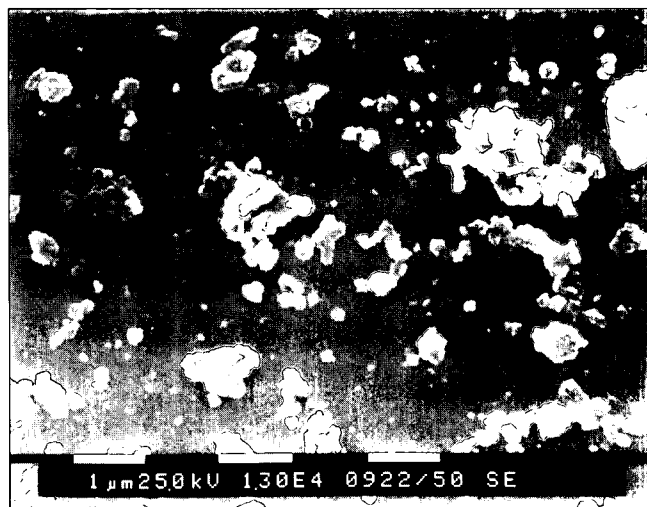
Abb. 3. REM-Foto der „<0,5 µm“-Fraktion von Illit-Chloriten aus der überlagernden Berchtesgadener Decke.
