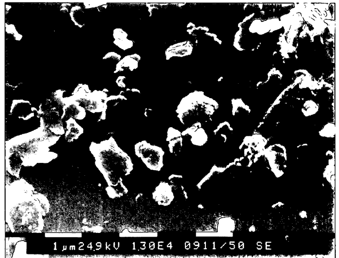
Abb. 10. REM-Fotographien von Feinfraktionen aus Proben des Südrandes der unterlagernden Tirolikum-Decke. „0,5–1,0 µm“-Fraktion separiert aus anchimetamorphem schwarzem Tonschiefer (No. 4, Hochkönig).
