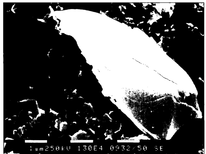
Abb. 11. REM-Fotografie der Feinfraktion „0,5–1,0 µm“ separiert aus einem grau-schwarzen Tonschiefer am Nordrand der unterlagernden Tirolikum-Decke (No. 17, Rauschberg).
