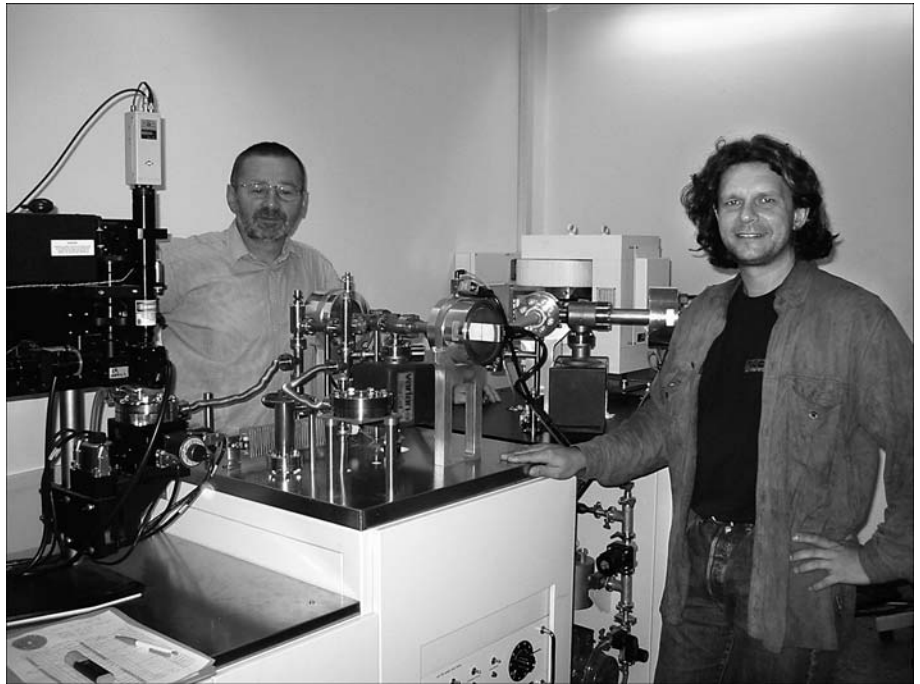
Abb. 22. MICROMASS NG 3600, Laser-Ablations- Gasmassenspektrometer, links hinten Prof. NEUBAUER, vorne Dr. HANDLER.
