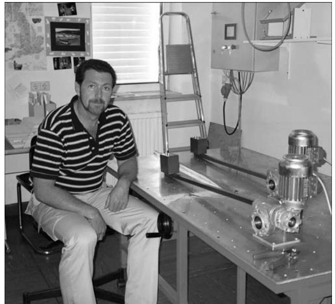
Abb. 23. A.M.A.Z.O.N.E. II, Analogmodellierungsanlage für strukturgeologische Experimente, links Ass.-Prof. Dr. STEYRER.
