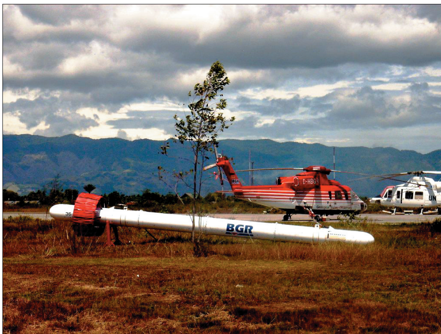
Abb. 7. Hubschrauber-Messsystem der BGR in der Einsatzvorbereitung in Banda Aceh (Insel Sumatra, Indonesien) auf der Suche nach Grundwasserpotenzialen als Hilfsmaßnahme nach dem Tsunami zu Weihnachten 2005. Foto: H.-J. REHLI.
