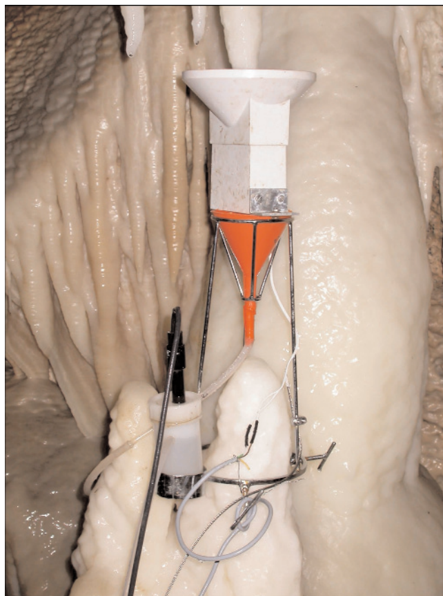
Abb. 36. In der „Perlenhalle“ des Rassl-Bumslucke-O2J-Systems (Obirhöhlen) wird die Tropfwassermenge und -zusammensetzung aktiver Stalagmite gemessen und aufgezeichnet. Bildbreite ca. 70 cm. Foto: C. SPÖTL.
