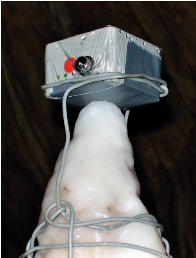
Abb. 16. Mit speziellen Sensoren (Modell Stalagmate, Kantenlänge ca. 8 cm) wird an ausgewählten Tropfsteinen im Katerloch (siehe Kap. 6.9) die Tropfaktivität aufgezeichnet. Foto: R. BOCH.
