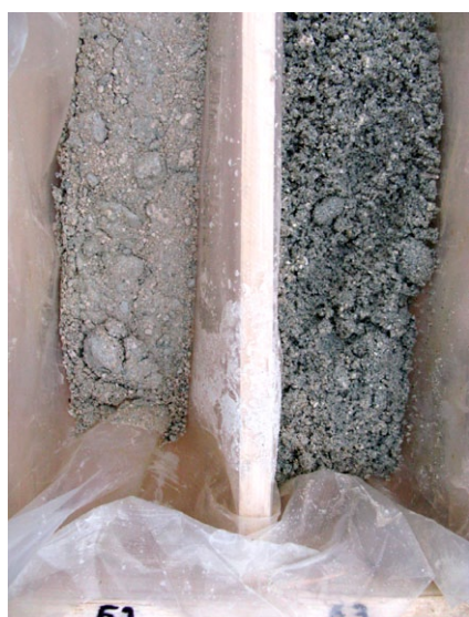
Abb. 15. Übergangsbereich LK – Rust-Formation in 62–63 m.
