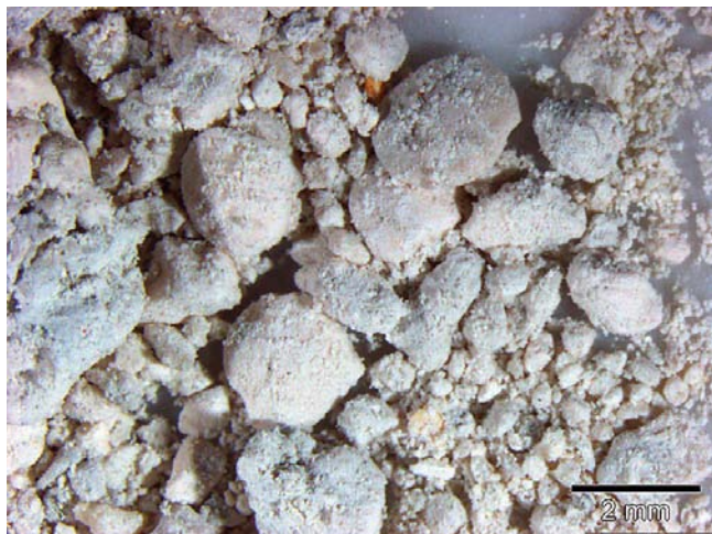
Abb. 29. Leithakalk, Probe aus 40 m Teufe (Nr. 091203-088).
