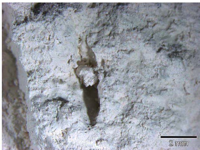
Abb. 30. Leithakalk, schluffig-krümelig, Probe aus 42,5 m Teufe (Nr. 091203-089).
