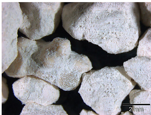
Abb. 28. Leithakalk, Probe aus 30,5 m Teufe (Nr. 091203-092).
