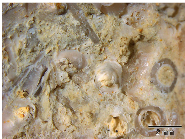
Abb. 27. Leithakalk, Probe aus 23,5 m Teufe (Nr. 091203-091).
