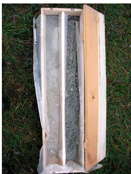
Abb. 16. Übergangsbereich LK – Rust-Formation in 63–64 m.
