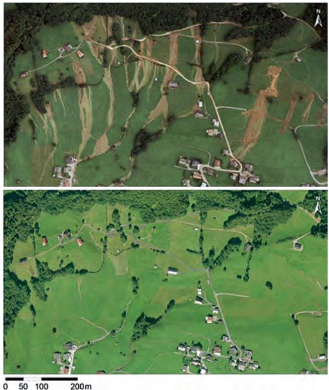
Abb. 5. Hangmuren im Bereich Berbigen/Vorsäß (Bregenzerwald). Mittels des zeitnahen Luftbildes sind die im August 2005 entstandenen Prozessbereiche und Standortverhältnisse im Abrissbereich der Hangmuren gut sichtbar (oben), während diese mittels eines Luftbildes von 2006 nicht mehr sichtbar bzw. identifizierbar sind (unten). Quelle der Luftbilder: WMS-Service der Vorarlberger Landesregierung.
