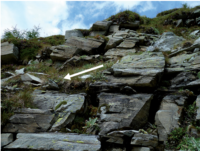
B. Bereich einer initialen Gleitung in siliziklastischen Metasedimenten der Wustkogel-Formation (Subpenninikum) mit Verbandsauflockerung, Öffnung der Trennflächen und beginnender Verstellung der Kluftkörper.
