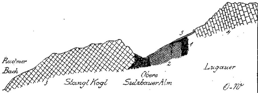
Fig. 6. 1 = Werfener Schichten, 2 = lichter Dolomit, 3 = Wettersteinkalk, 4 = Dachsteinkalk, 5 = Gehängebreccie.
