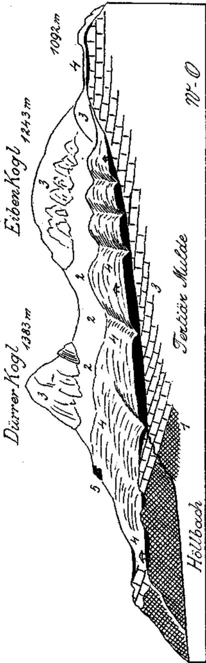
Fig. 1. 1 und 2 = weißer Dolomit, 3 = Dachsteinkalk, 4 = tertiäre Mergel-Sandsteine und Konglomerate, 5 = Gehäugebrecce.
