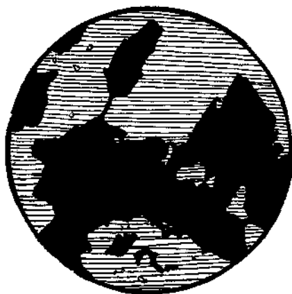
Text-Abb. 6. Bleiglanzkörner (schwarz) in Blende (schraffiert); mechanisches Einspitzen des Bleiglanzes zwischen Blendekörner und Eindrücken von Blende in Bleiglanz. Vergr. zirka 15 fach. Bismarkstollen — Ost.
