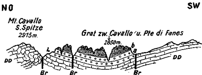
Fig. 15. Profil (von N gesehen) durch den Einbruch der Scholle von Lias ( L ) und Dachsteindolomit ( DD ) am Grat südlich von Monte Cavallo. Maßstab ca. 1 : 8000. a = Liassbreccien, b = Liaskalk und Mergel, Br = Brüche.
