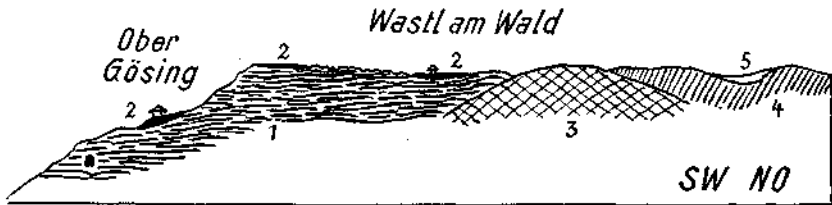
Fig. 16. 1 = Dünn-schiefrige, stark durchfaltete Gutensteiner Kalk. 2 = Lunzer Sandsteine. 3 = Hauptdolomit. 4 = Dachsteinkalk. 5 = Grauer, schöner Krinoidenkalk mit schwarzen Hornsteinwucherungen. Unterhalb von Ober Gösing befindet sich der Eisenbahntunnel der Mariazeller Bahn.
