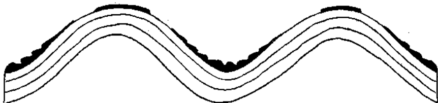
Fig. 19. Lokale Gleitungen an den Gewölbeffanken.
